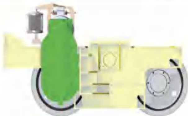
行星车轮组门吊大车运行机构
